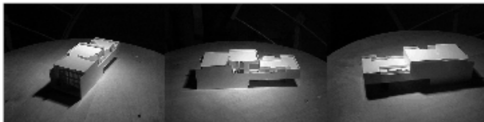
Figura 7 - Simulação de insolação as 15:00 horas – heliodon – detalhe da iluminação
