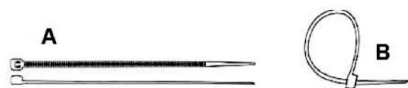
Figura 2. Desenhos esquemáticos da abraçadeira de náilon 6.6 (poliamida) com as bordas destravadas em A e com o laço formado em B . (Fonte: MIRANDA et al., 2006).
